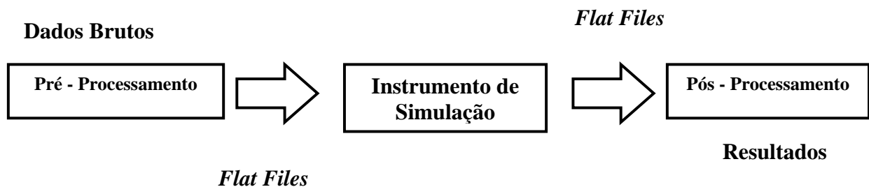
Figura 7 – Idéia de Funcionamento do SIMMOD. Fonte: Delcaire & Feron, 1997.
